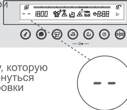
Если Вы пропустили температуру, которую хотели выставить, вы можете вернуться к ней, нажимая на кнопку регулировки температуры воды.
