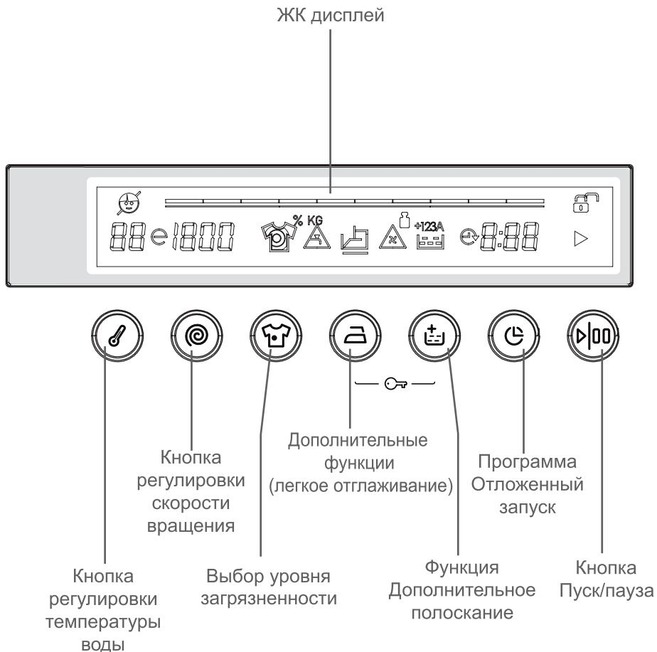
На ЖК дисплее Вы можете увидеть температуру воды, скорость отжима, время окончания стирки, закрыта ли дверца или нет, выбранные дополнительные функции и этап выбранной программы.
