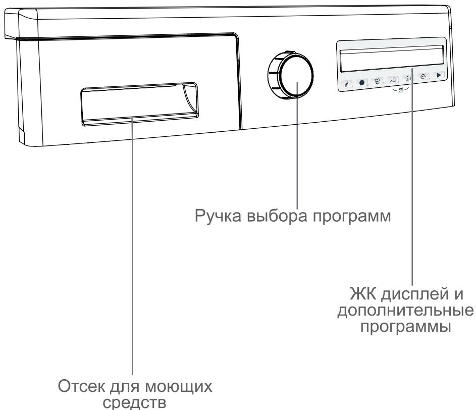
При использовании жидкого моющего средства можно установить мерную пластинку в отделение для моющих средств. Во всех программах, кроме предварительной стирки, можно применять жидкое моющее средство. Для этого вставьте во второе отделение для моющих средств (\*) мерную пластину и налейте в него жидкое моющее средство в соответствии с метками на пластине. (Соблюдайте рекомендации по применению и дозировка моющего средства, указанные на его упаковке.)
