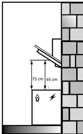
Перед установкой вытяжки проверьте, чтобы стена, на которую будет подвешиваться вытяжка, была достаточно прочной. Для подвески вытяжки и планки крепления декоративного короба используйте шурупы и дюбели соответствующие типу стены в Вашей кухне (железобетон, гипсокартон и т.д). Если шурупы и дюбели входят в комплект поставки, следует удостовериться в том, что они подходят для того типа стены, на который будет подвешиваться вытяжка.
