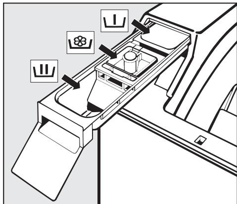
■ Выдвиньте отсек для моющих средств и заполните ячейки моющим средством.
