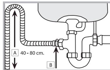
Перед подсоединением сливного шланга к сифону мойки снимите пластиковую пробку (В).
