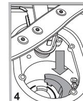
После чистки фильтров точно установите фильтрующий узел на свое место, что является важным для исправной работы посудомоечной машины.
