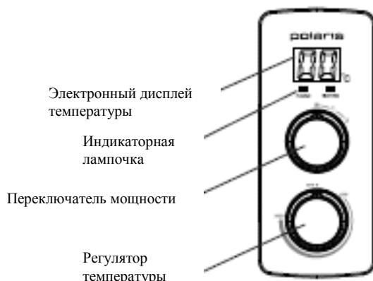
1. С помощью переключателя мощности установите необходимую мощность (1300Вт /2000Вт). От выбора мощности зависит скорость (время) нагрева воды до заданной температуры. При включении переключателя мощности в позицию «1» прибор работает с мощностью 1300Вт. При включении переключателя мощности в позицию «2», прибор работает с мощностью 2000Вт. Горящая индикаторная лампочка обозначает нагрев воды.
