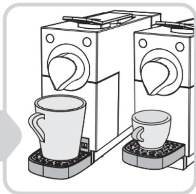
**Размер чашек:** в зависимости от размера чашек установите поддон в верхнее или нижнее отверстие:
