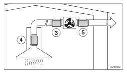
Чтобы шум работы вентилятора на кухне был минимальным, шумоподавитель должен быть расположен перед выносным вентилятором ③, как можно ближе к нему; при длинном воздуховоде - на штуцере воздуховода вытяжки ④. Если выносной вентилятор смонтирован в доме, то использование шумоподавителя сзади вентилятора ⑤ может уменьшить шум от его работы.
