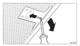
Если фильтр был случайно установлен наоборот: разблокируйте фиксатор через выемки с помощью небольшой отвертки.
