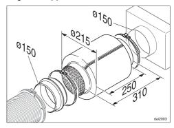
В воздуховод может быть установлен шумоподавитель (дополнительно приобретаемая принадлежность). Он предназначен для дополнительного снижения шума.
