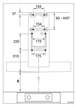
■ Если сначала изготавливается задняя стенка, в которой должны быть отверстия для крепления, то необходимо соблюдать указанные на плане промежутки между отверстиями (шурупы Ø 5 мм).
