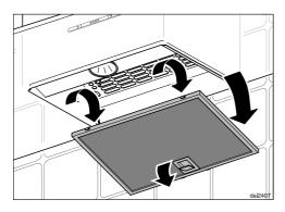
Ослабить фиксатор фильтра, наклонить фильтр примерно на 45° вниз, вывести из паза и снять.
