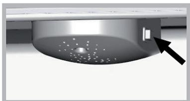
Функция Active Oxigen активна, устройство работает в соответствии со своим циклом (в режиме до деактивации(отключения) функции), эмиссия озона обозначена включением светодиода зеленого цвета внутри холодильной камеры на устройстве, цикл stand by (ожидание без эмиссии озона) обозначен включением светодиода голубого цвета
