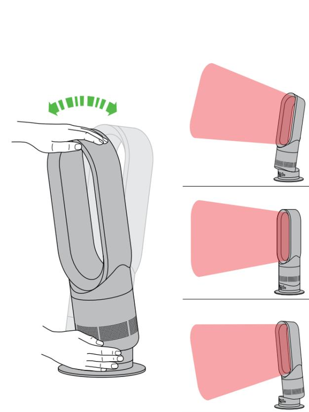
Previdno držite osnovno enoto in vrh obroča za ojačanje zračnega toka. Za nastavitve kota zračnega toka potisnite obroč naprej ali nazaj.
