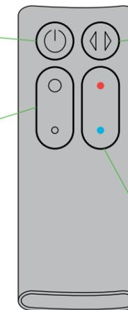
Включение/выключение управления распределением воздушного потока (вращение нагревателя в горизонтальной плоскости)
