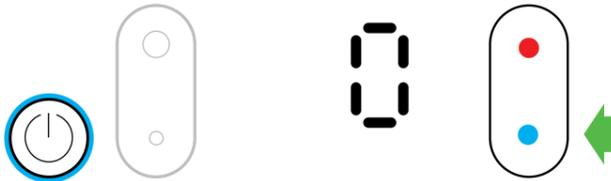
Pritisnite moder gumb za nadzor termostata, da spremenite ciljno temperaturo na 0° C. Barva lučke na gumbu za napajanje se bo spremenila iz rdeče v modro. Za prilagoditev hitrosti zračnega toka uporabite nadzor hitrosti zračnega toka.
