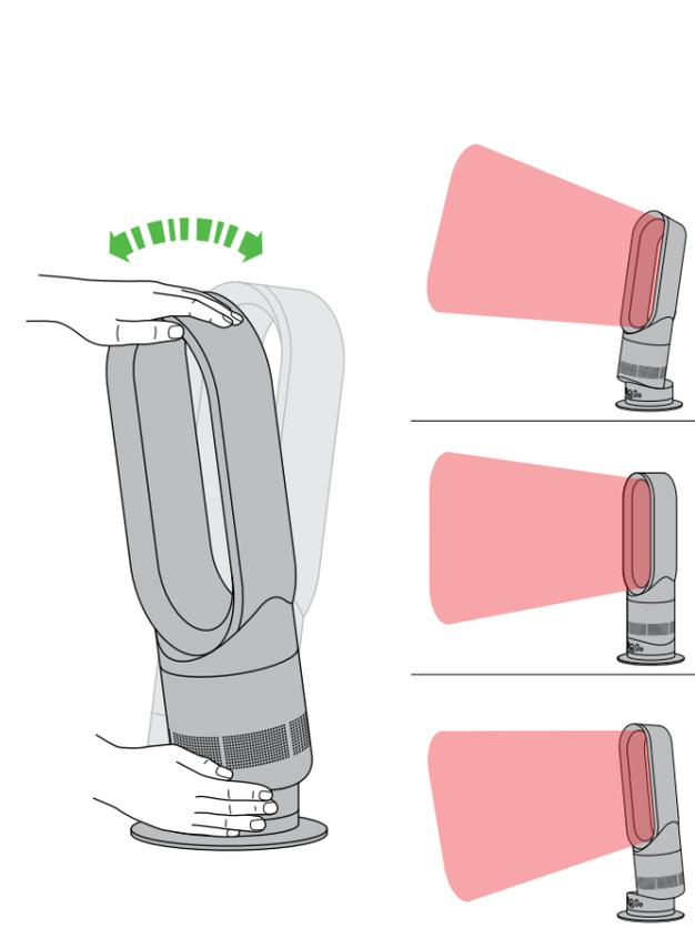
Die Basiseinheit vorsichtig an Unter- und Oberseite festhalten. Das Gerät im gewünschten Luftstromwinkel nach vorne oder hinten ausrichten.
