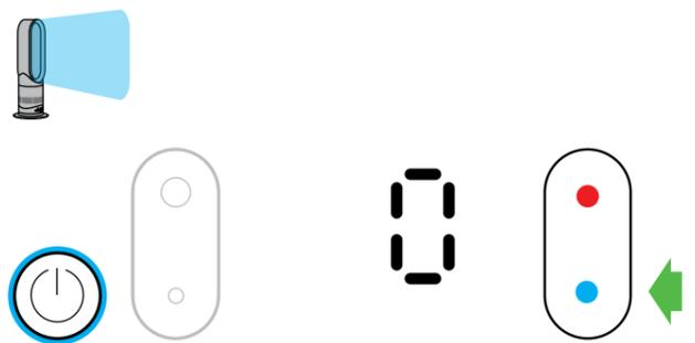
Appuyer sur le bouton de commande bleu du thermostat pour régler la température sur 0°C. Le voyant du bouton marche/arrêt passera de rouge à bleu. Pour ajuster la puissance du souffle d'air, utiliser la commande de contrôle de la puissance du souffle d'air.
