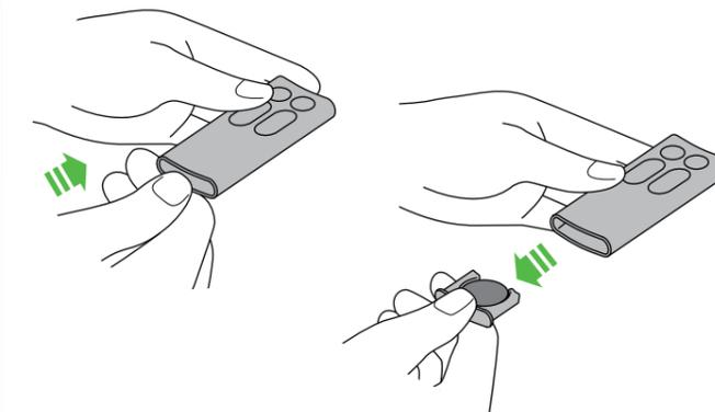
Press the end of the remote to release the battery. Appuyer sur l'extrémité de la télécommande pour libérer la pile. Das Ende der Fernbedienung drücken, um die Batterie zu lösen. Druk op de achterkant van de afstandsbediening om de batterij los te maken.
