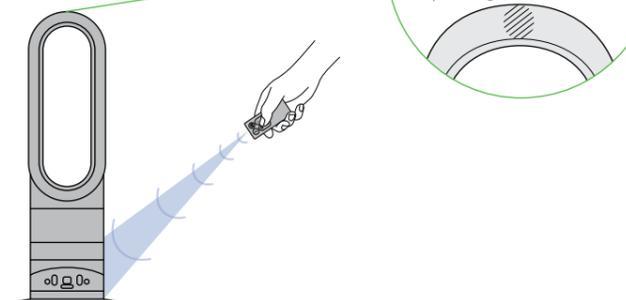
Zur Bedienung richten Sie die Fernbedienung auf die vordere Seite des Sockels.
