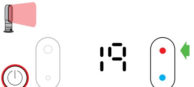
Presione el botón rojo de control del termostato hasta que la temperatura deseada aparezca en la pantalla digital. El piloto de encendido cambiará de azul a rojo.
