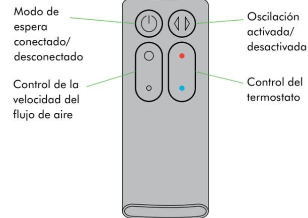
El mando a distancia se fija magnéticamente. Fije el mando a la parte superior del calefactor con los botones orientados hacia abajo.
