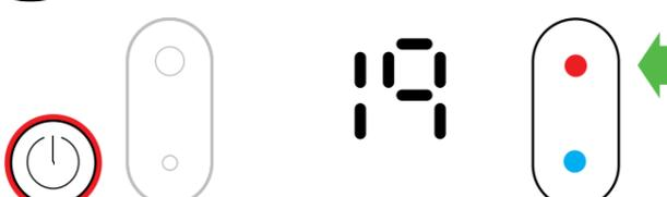
Pritisnite in držite rdeč gumb za nadzor termostata, dokler se na digitalnem prikazovalniku ne prikaže zelena ciljna temperatura. Barva lučke na gumbu za napajanje se bo spremenila iz modre v rdečo.
