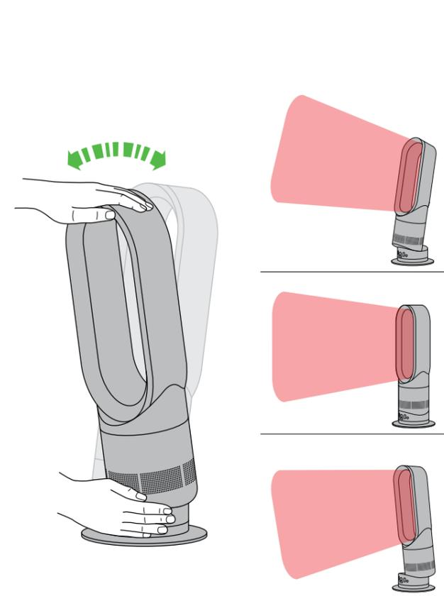
Sujete con cuidado la base y la parte superior del bucle amplificador de aire. Inclínelo hacia adelante o hacia atrás hasta conseguir el ángulo deseado de flujo de aire.
