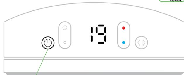
Jedes Mal, wenn Sie die Heizfunktion Ihres Gerätes auswählen, benötigt das Gerät eine kurze Zeit um sich auf die gewählte Funktion einzustellen. Dabei wird der Luftstrom für kurze Zeit automatisch gesteuert ehe das Gerät auf der von Ihnen gewünschten Luftstromeinstellung und Temperatur arbeitet.
