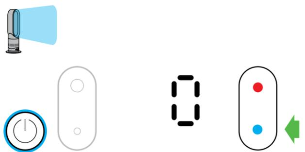
Stellen Sie durch Drücken der blauen Thermostatreglertaste die Solltemperatur auf 0 °C. Der Ein-/Ausschalter leuchtet nun blau anstelle von rot. Zum Einstellen der Luftstromgeschwindigkeit drücken Sie die entsprechende Taste.
