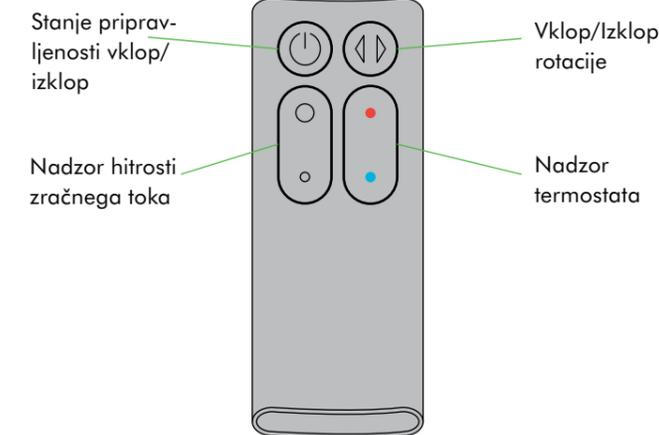
Daljinsko upravljanje se priključi z magnetom. Postavite daljinski upravljalnik na vrh grelca s tipkami navzdol.
