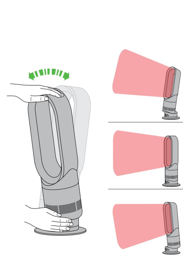
Saisir avec précaution la base et le haut de l'anneau amplificateur d'air. Incliner l'appareil vers l'avant ou l'arrière pour obtenir l'angle de souffle d'air souhaité.
