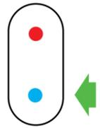
Нажмите синюю кнопку управления термостатом для изменения температуры до 0°C. Индикатор кнопки включения изменит цвет с красного на синий. Для регулировки скорости воздушного потока используйте элементы управления скоростью воздушного потока.
