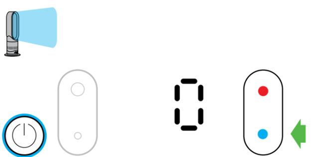
Presione el botón azul de control del termostato para cambiar la temperatura deseada a 0 °C. El piloto de encendido cambiará de rojo a azul. Para ajustar la velocidad del flujo de aire, utilice el control de la velocidad del flujo de aire.
