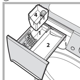
Эта функция служит для удаления наиболее трудных пятен. Вставьте дополнительный прилагаемый дозатор 4 в дозатор 1. При заливке отбеливателя не превышайте "макс." уровень, указанный на стержне в центре (см. схему). Для выполнения только отбеливания залейте отбеливатель в дополнительный дозатор 4, выберите программу "Полоскание" и включите дополнительную функцию "Удаление пятен"
