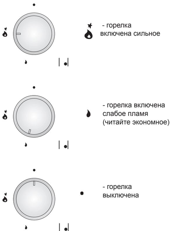
На рис.6 изображено, как правильно отрегулировать пламя горелки.
