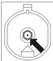
*Замена форсунки горелки форсунку выкрутить с помощью специального насадочного ключа 7 и заменить на новую, соответственно виду газа (см. таблицу выше).*
