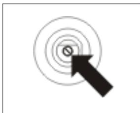
Чтобы проверить пламя, нужно прогреть горелку на полном огне в течении 10 мин., а далее повернуть регулировочную ручку вентиля на экономное пламя. Огонь не должен гаснуть и перескакивать на форсунку. А если так произойдет, необходимо повторить регулировку вентилей.
