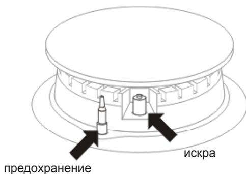
В моделях плит, которые оснащены системой противоутечки газа из конфорок, необходимо во время поджигания придерживать около 10 сек утопленную до упора ручку в положении «сильный огонь»,
