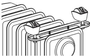
4. Надежно зафиксируйте роликовые колесики, закрутив две барашковые гайки.
