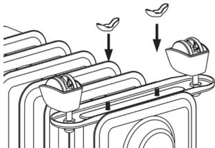
5. Аналогичным способом закрепите вторую пару роликовых колесиков.
