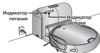
1. Совместите контакты для подзарядки на корпусе пылесоса с контактом на зарядной станции, а затем нажмите на корпус пылесоса. Зарядное устройство должно подать соответствующий звуковой сигнал.
