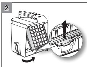
2 Надавите на фиксирующую часть фильтра в указанном стрелкой направлении.
