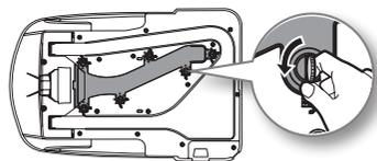
2. Удалите нижнюю крышку из автоматического опорожнителя с помощью монеты и очистите нижнюю крышку.
