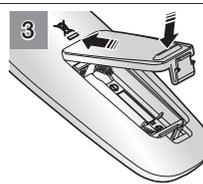
3 Вставьте выступ на крышке в паз, а затем опустите другой конец крышки, чтобы она зафиксировалась с щелчком на своем месте.
