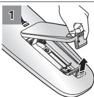
1 На задней стороне пульта дистанционного управления нажмите фиксатор и поднимите крышку отсека для батарей.
