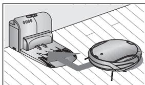
При низком уровне заряда батареи роботизированный пылесос автоматически подъезжает к зарядному устройству для быстрой автоматической подзарядки батареи.
