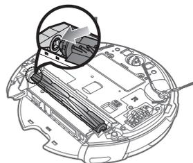
5. Вставьте один край щетки в два паза и плавно сдвигайте его вниз до щелчка.
