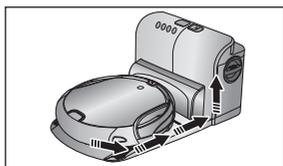
Когда роботизированный пылесос возвращается в автоматический опорожнитель после уборки, пыль из роботизированного пылесоса выгружается автоматически.
