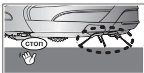
При поднятии роботизированного пылесоса во время уборки ведущие колеса, приводная щетка, двигатель всасывания и боковая вращающаяся щетка автоматически останавливаются с помощью датчика.
