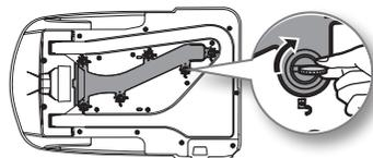
7. Следует периодически очищать нижнюю сторону автоматического опорожнителя.
