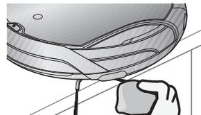
4. Если между корпусом и боковой вращающейся щеткой есть волосы или нити, открутите винт боковой вращающейся щетки с помощью крестовой отвертки и удалите волосы или нити. При установке щетки на место совместите метку "L" на боковой вращающейся щетке для очистки вдоль стен с меткой "L" на корпусе пылесоса. (Правую боковую щетку выравнивайте по метке "R".)
