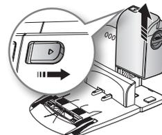
2. Сдвиньте стопорный элемент вниз, чтобы открыть крышку пылесборника.
