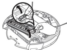
2. Извлеките приводную щетку из корпуса пылесоса.
