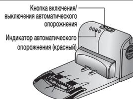
3. Когда роботизированный пылесос становится в автоматический опорожнитель, запускается автоматическое опорожнение пыли.
