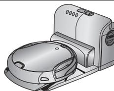
4. Если контейнер автоматического опорожнителя для пыли заполнен, включается индикатор заполнения. Опорожните пылесборник автоматического опорожнителя. Выполните очистку всасывающего отверстия на нижней стороне пылесоса. Очистите фильтр.
