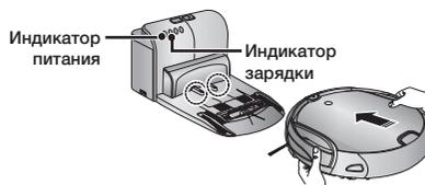
2. Проверьте состояние зарядки роботизированного пылесоса.
