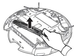
3. С помощью чистящей щетки или пылесоса удалите посторонние предметы, например длинные волосы или нити, намотавшиеся на приводную щетку.
