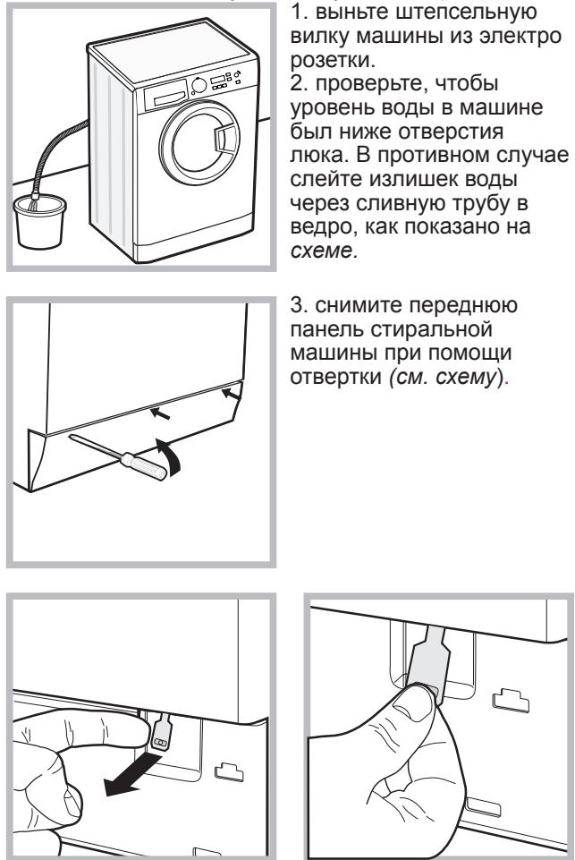
4. потяните наружу язычок, показанный на схеме, вплоть до освобождения пластикового блокировочного винта. Затем потяните его вниз и одновременно откройте люк.
