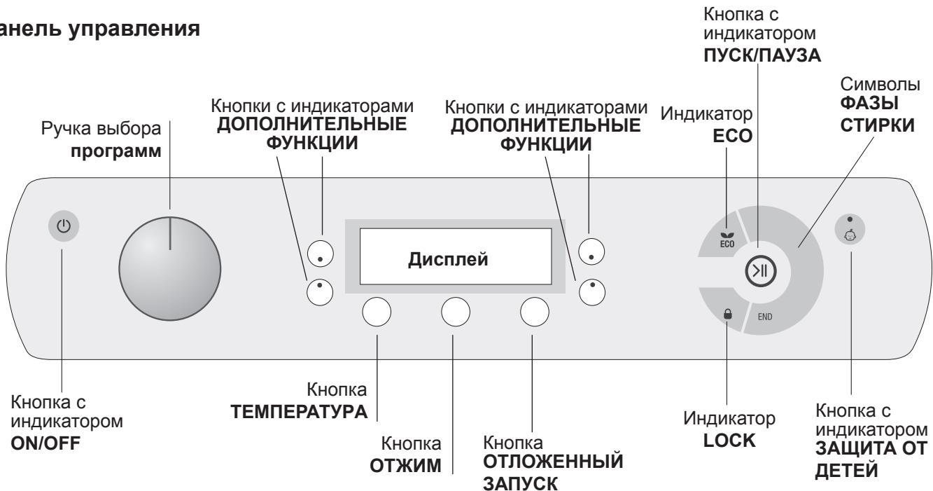
**Кнопка с индикатором ON/OFF:** нажмите кнопку один раз для включения или выключения машины. Зеленый индикатор показывает, что машина включена. Для выключения стиральной машины в процессе стирки необходимо держать нажатой кнопку примерно 3 секунды. Короткое или случайное нажатие не приведет к отключению машины. В случае выключения машины в процессе стирки текущий цикл отменяется.
