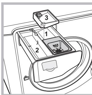
вставьте дополнительный прилагающийся дозатор 3 в ячейку 1. При заливке отбелителя не превышайте "макс." уровень, указанный на стержне в центре (см. схему). Для выполнения только отбеливания без полного цикла стирки залейте отбелитель в дополнительный дозатор 3, выберите программу «Полоскание» и включите дополнительную функцию «Суперстирка» .
