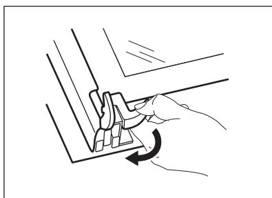
5. Отожмите стопоры, чтобы снять внутреннюю стеклянную панель.
