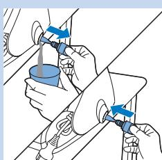
**3** Под клапаном EASY DE-CALC поставьте чашку. Поверните клапан EASY DE-CALC против часовой стрелки, слейте воду с частицами накипи в чашку. Когда из парогенератора перестанет поступать вода, установите клапан EASY DE-CALC на место и поверните его по часовой стрелке для фиксации. Подключите прибор к электросети.
