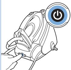
**1** Чтобы включить режим ECO, нажмите и удерживайте кнопку включения/выключения в течение 2 секунд. Индикатор загорится зеленым светом.
