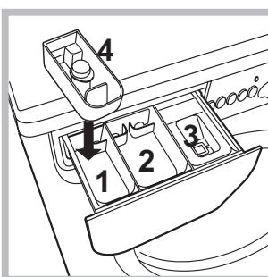
Эта функция служит для удаления наиболее трудных пятен. Вставьте прилагающийся дополнительный дозатор 4 в ячейку 1. Не заливайте отбеливатель в дозатор выше отметки «макс.» на центральной шкале (см. рисунок). Для осуществления только отбеливания поместите отбеливатель
