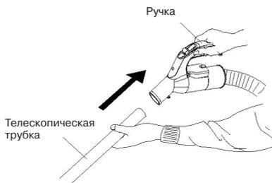
3. Установите необходимую длину телескопической трубки. Для этого нажмите на кнопку фиксации телескопической трубки (7) и выдвиньте трубку на не необходимую длину.
