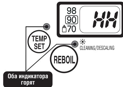
При срабатывании защиты одновременно светятся индикаторы кипячения и сохранения тепла, а на жидкокристаллическом дисплее отображаются символы HH.
