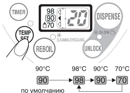
Если вы хотите, чтобы термопот поддерживал после кипячения другую температуру жидкости, воспользуйтесь кнопкой установки температуры TEMP SET, пока вода закипает. Каждое нажатие этой кнопки перемещает указатель-треугольник на жидкокристаллическом дисплее на следующую позицию, задавая соответствующий режим.
