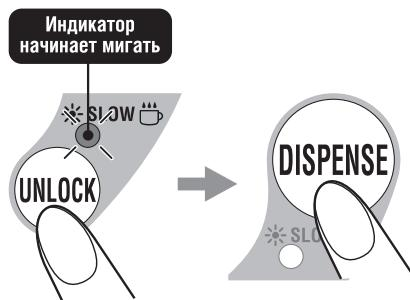
Чтобы вернуться к обычному режиму еще раз нажмите кнопку UNLOCK.
