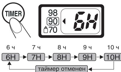
Чтобы установить таймер нажмите кнопку TIMER до тех пор, пока на жидкокристаллическом дисплее не отобразится нужный временной интервал.
