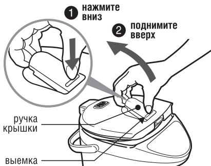
Закрывая крышку, надавите на нее до характерного щелчка, говорящего о срабатывании замка крышки.
