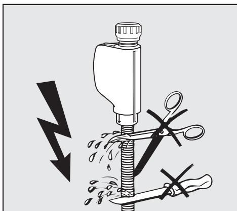
**⚠ Не** допускается укорачивание или повреждение шланга подачи воды, так как в нем имеются детали, находящиеся под напряжением (см. рисунок).
