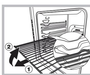
**ВНИМАНИЕ!** Духовой шкаф укомплектован системой блокировки решеток, позволяющей вынимать их из духовки не полностью (1). Для полного вынимания решеток достаточно поднять их, как показано на схеме, взяв их за передний край, и потянуть на себя (2).
