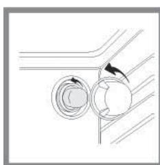
1. Отключите оборудование от электросети, затем снимите стеклянный плафон с патрона лампы (см. рис.).
