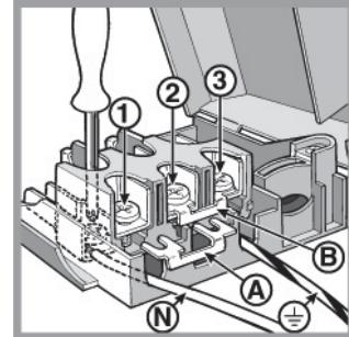
3. Разместите провода N и  $\text{PE}$  в соответствии со схемой подсоединения (см. рис.) и затяните как можно туже винты на их контактах.
