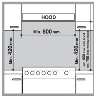
Минимальное расстояние между рабочей поверхностью плиты и навесными шкафами (полками) должно составлять 420 мм. Это расстояние следует увеличить до 700 мм, если навесные шкафы сделаны из горючих материалов (см. рис.).
