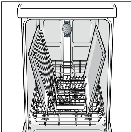
С помощью этой разбрызгивающей головки Вы можете помыть большие противни или решетки, а также тарелки диаметром более 30 см (тарелки для гурманов, тарелки для спагетти, тарелки-подставки). Для этого следует снять верхнюю корзину и установить разбрызгивающую головку, как изображено на рисунке.
