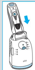
Теперь при необходимости будет осуществляться зарядка бритвы. Устройство чистки и подзарядки Clean&Renew производит анализ на уровень загрязнения бритвы, результат анализа отображается включением одного из индикаторов дисплея программы чистки ⑤:
