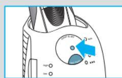
В процессе чистки индикатор соответствующей программы чистки будет мигать. Каждая программа чистки состоит из нескольких циклов, при которых чистящая жидкость пропускается через бреющую головку бритвы и включается процесс горячей сушки. Общее время чистки зависит от выбранной программы и в среднем составляет от 32 до 43 минут.
