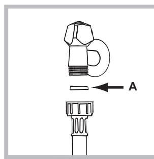
1. Вставьте прокладку A в конец заливного шланга и наверните его на вывод водопровода холодной воды с резьбовым отверстием 3/4 дюйма (см. рис.). Перед подсоединением откройте водопроводный кран и дайте стечь грязной воде.
