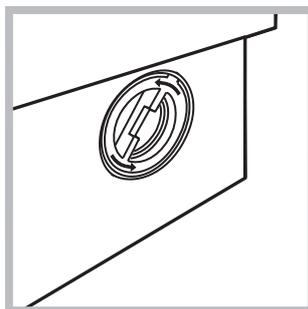
2. отвинтите крышку, повернув ее против часовой стрелки (см. схему): небольшая утечка воды является нормальным явлением;
