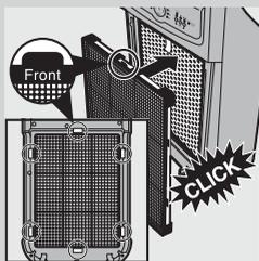
**9** Чтобы установить на место переднюю панель, сначала вставьте в верхнюю часть прибора два верхних крючка (1). Затем прижмите панель к корпусу прибора (2).
