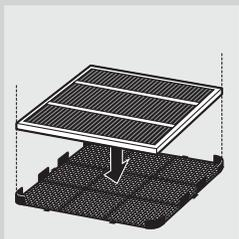
**8** Установите фильтр предварительной очистки обратно в прибор. Закрепите все крючки на приборе.
