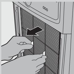
**3** Чтобы извлечь фильтр предварительной очистки, возьмитесь за два выступа и потяните фильтр на себя .
