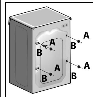
Открутите 4 винта (A) на задней стенке и извлеките 4 распорных втулки (B).
