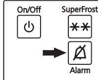
Звуковая сигнализация отключается нажатием кнопки **ALARM** [Сигнализация].
