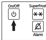
**Для выключения устройства:** нажимайте кнопку «On/Off» в течение примерно 3 секунд, пока дисплей не погаснет.
