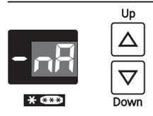
Если нажать на кнопку «ALARM» во время отображения индикации «nA», то на дисплее отобразится максимальная температура, которая была зафиксирована во время сбоев электропитания. Проверьте качество продуктов и их пригодность для потребления в том случае, если в морозильной камере становилось слишком тепло или если продукты даже разморожены.
