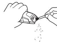
5. Удалите волоски между неподвижным и рабочим лезвиями. Для этого нажмите на рычаг очистки, чтобы поднять рабочее лезвие.
