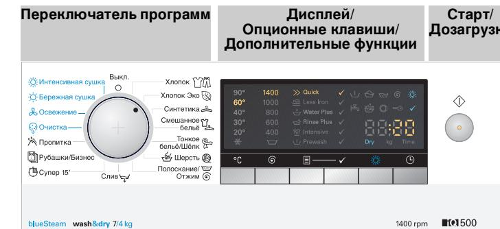
1 Переключатель программ для включения и выключения машины и для выбора программы. Можно поворачивать в оба направления. Подробный обзор программ → Стр. 7/8
