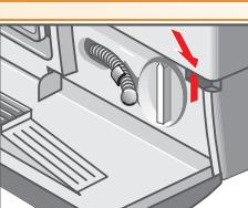
Программа продолжается после возобновления подачи тока. В случае необходимости выгрузки белья из машины дверцу можно открыть следующим образом:
