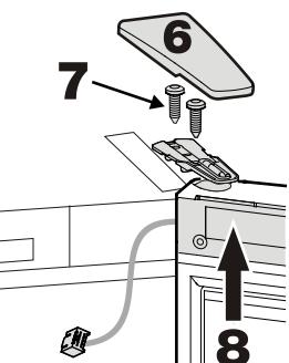
9. Переставьте защитную крышку на противоположную сторону.
