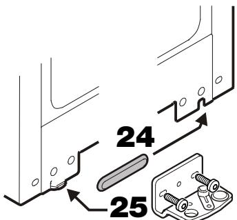
**24.** Переставьте защитную крышку на противоположную сторону.
