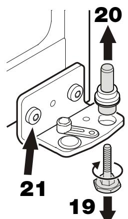
22. Переставьте опору шарнирного уголка на противоположную сторону.
