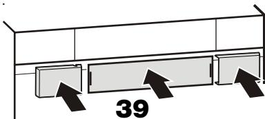
**29.** С помощью отвертки снимите крышку с двери.
