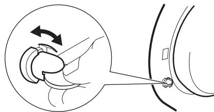
Для отключения этого устройства, чтобы снова можно было закрыть дверцу, поверните кнопку против часовой стрелки так, чтобы паз оказался в вертикальном положении.
