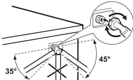
3. Отрегулируйте положение шланга, ослабив зажимную гайку. Отрегулировав положение шланга, не забудьте плотно затянуть зажимную гайку во избежание утечек.
