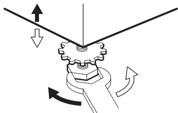
Тщательное выравнивание предотвращает вибрацию, шум и перемещение машины во время работы.
