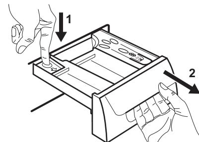
Промойте его проточной водой, чтобы удалить все остатки скопившегося порошка.
