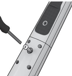
**2. Закрепите ручку, затянув прилагаемый крепежный винт.** Воспользуйтесь отверткой или монетой.
