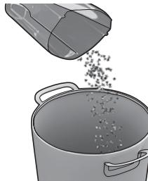
**2. Опорожнение пылесборника.** Выньте фильтры и вытряхните содержимое в мусорное ведро. Установите фильтры и защелкните пылесборник на место.
