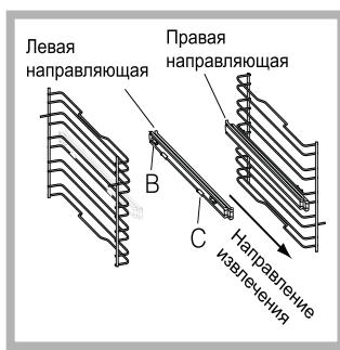
2. Выберите уровень, на который будет установлена выдвижная направляющая. Проверив направление выкатывания самой направляющей, установите на раму сначала крепление В, а затем С.
