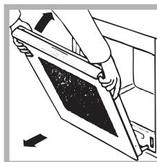
3. возьмитесь за дверцу руками с двух сторон, плавно закройте ее, но не полностью. Затем потяните дверцу на себя, снимая ее со своего гнезда (см. схему). Для установки дверцы на место выполните вышеописанные операции в обратном порядке.
