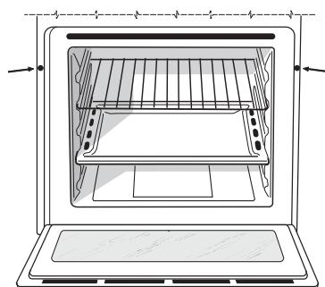
! Все защитные элементы должны быть закреплены таким образом, чтобы их можно было снять только при помощи специального инструмента.
