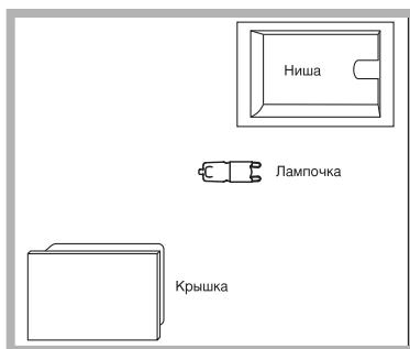
1. Снимите стеклянную крышку плафона лампочки.
