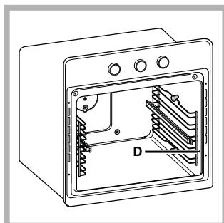
3. Закрепите две рамы с установленными направляющими в специальных отверстиях в стенках духового шкафа (см. схему). Отверстия левой направляющей расположены сверху, а правой – снизу.
