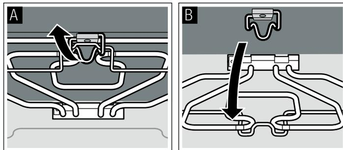
После окончания очистки снова закрепите нагревательный элемент гриля вверх. Сместите зажим гриля вниз и вставьте нагревательный элемент на место.
