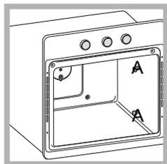
1. Отвинтите два шурупа А (см. рисунок). Если духовой шкаф оснащен самоочищающимися панелями, они окажутся временно снятыми.
