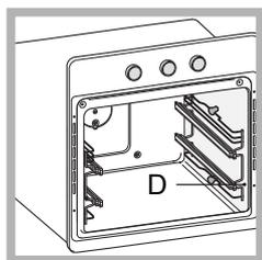
4. Закрепите два крепежных элемента D направляющей в специальных отверстиях в стенках духовки (см. рисунок). Отверстия левой направляющей расположены сверху, а правой – снизу.
