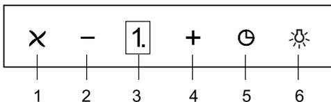
1. Включение/выключение вытяжки
