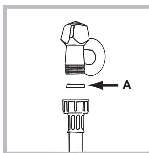
2. Вставте прокладку А у кінець шлангу для подачі води та вкрутіть його у кран з холодною водою з різьбою 3/4 (див. малюнок). Перед підключенням спустіть воду, доки вона не стане прозорою.
