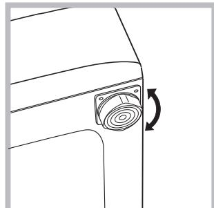
2. Выровняйте машину при помощи регулируемых ножек до полного выравнивания (наклон не должен превышать 2-х градусов).
