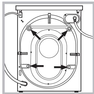
2. Видаліть 4 запобіжних гвинти для транспортування і відповідну розпірну деталь, розташовану ззаду (див. малюнок).
