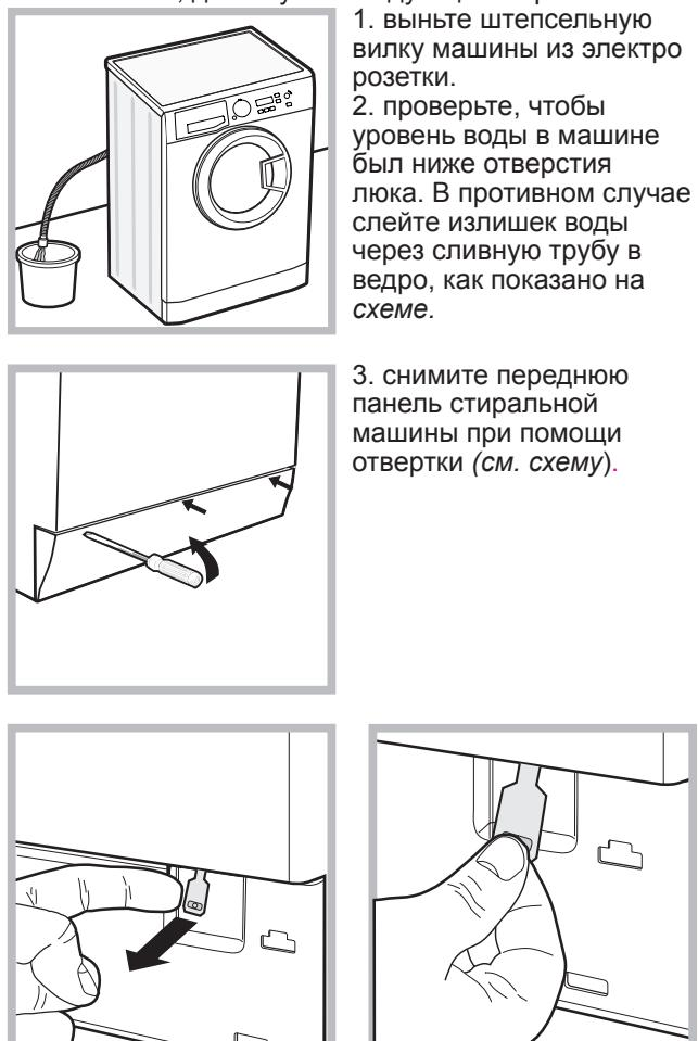
1. выньте штепсельную вилку машины из электро розетки.
