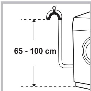
Подсоедините сливной шланг, не сгибая его, к сливному трубопроводу или к настенному сливу, расположенному на высоте 65 – 100 см от пола.
