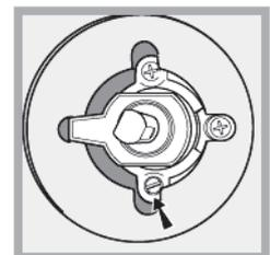
! В случае использования природного газа регулировочный винт следует ослабить, отвернув его против часовой стрелки.
