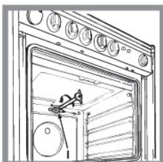
2) специальным торцевым ключом для жиклеров или 7 мм торцевым ключом (см. *рис.*) отвинтите жиклер горелки гриля и замените его подходящим для нового типа газа (см. табл. *Характеристики горелок и жиклеров*).
