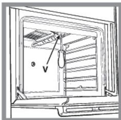
1) отверните винт «V» и снимите горелку (см. *рис.*);
