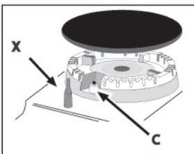
В моделях, имеющих устройство электронного зажигания\* (C), нажмите кнопку электронного зажигания, обозначенную символом
