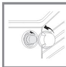
1. Отключите оборудование от электросети, затем снимите стеклянный плафон с патрона лампы.
