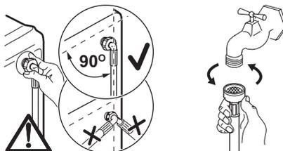
В случае необходимости передвиньте наливной шланг в направлении, показанном на рисунке. Для этого ослабьте зажимную гайку и расположите наливной шланг вниз, как показано на рисунке. Затяните зажимную гайку и проверьте соединение на отсутствие протечки.
