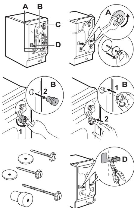
Сохраните транспортировочные болты на случай, если придется перевозить прибор.
