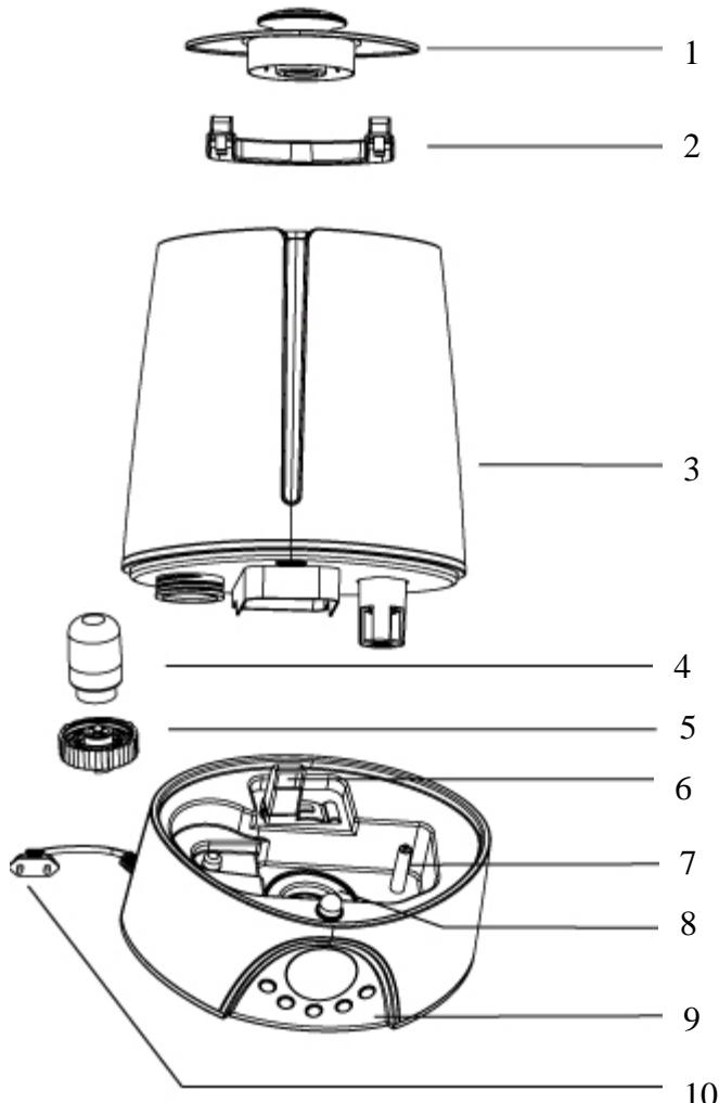
1. Диффузор для выхода пара
