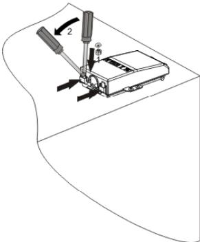
Anschlussdose öffnen: Zum Entriegeln Schraubendreher ansetzen (1) und geringfügig nach unten bewegen (2).
