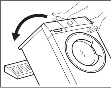
6. En kos polistirenske embalaže položite na tla za napravo. Napravo pazljivo nagnite na hrbtno stran. Pazite, da ne boste poškodovali cevi.
