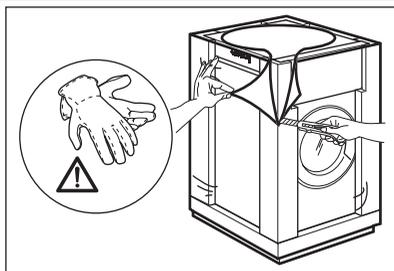
1. Используйте перчатки. Снимите закрывающую прибор пленку. При необходимости, воспользуйтесь режущим инструментом.
