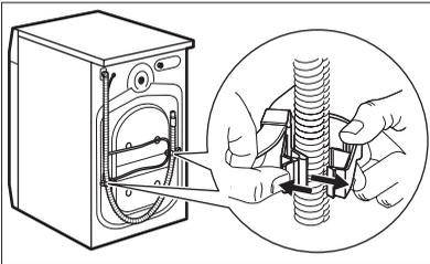
9. Iz držal za cevi odstranite napajalni kabel in cev za odvod vode.
