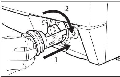
9. Очистите фильтр, находящийся под водопроводным вентилем, и вставьте его обратно в насос по специальным направляющим.
