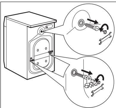
10. Odstranite tri vijake. Uporabite ključ, priložen napravi.
