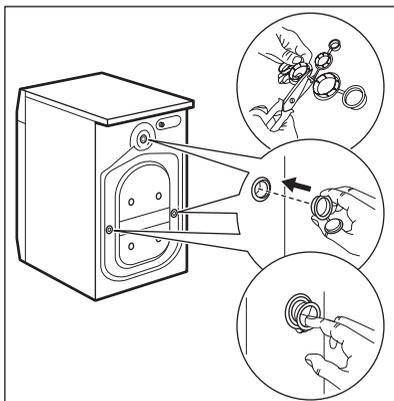
12. Вставьте в отверстия пластиковые заглушки. Заглушки находятся в пакете с инструкцией по эксплуатации.
