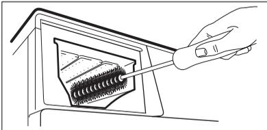
5. Очистите нишу дозатора с помощью щетки.
