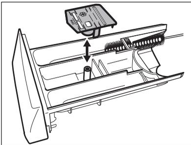
3. Снимите верхнюю часть отсека для жидких добавок.
