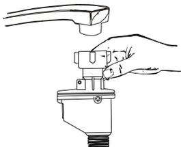
Подсоедините шланг подачи холодной воды к резьбовому соединителю (3/4") и убедитесь в том, что соединение плотно затянуто.
