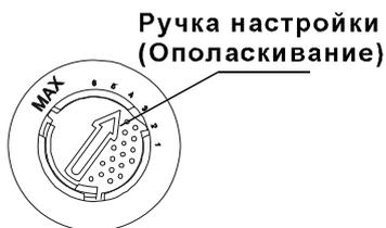
В дозаторе ополаскивателя предусмотрено четыре или шесть положений настройки. Всегда начинайте работу с переключателем дозатора в положении 2. Если при этом имеют место пятна и неэффективная сушка, то следует увеличить количество подаваемого ополаскивателя.
