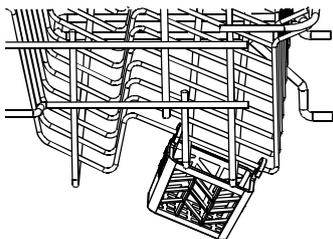
2. Поверните верхний разбрызгиватель и, если нужно, измените положение емкости так, чтобы верхний разбрызгиватель не задевал емкость для таблеток «3 в 1».
