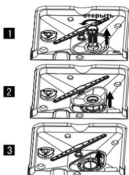
Шаг 1: повернуть грубый фильтр против часовой стрелки, а затем вытянуть его вверх.
