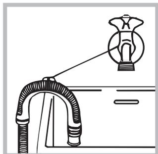
или поместите шланг в раковину или в ванну, закрепив прилагающуюся направляющую к крану (см. схему). Свободный конец сливного шланга не должен быть погружен в воду.
