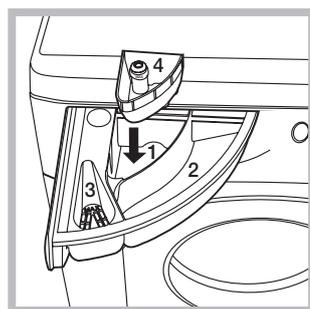
Эта функция служит для удаления наиболее трудных пятен. Вставьте прилагающийся дополнительный дозатор 4 в ячейку 1. Не заливайте отбеливатель в дозатор выше отметки «макс.» на центральной шкале (см. рисунок). Для осуществления только отбеливания поместите отбеливатель в дополнительный дозатор 4 и задайте программу
