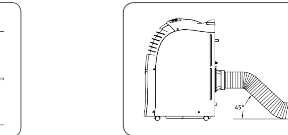
**УСТАНОВКА ОКНОННОЙ ВЫТЯЖКИ**
