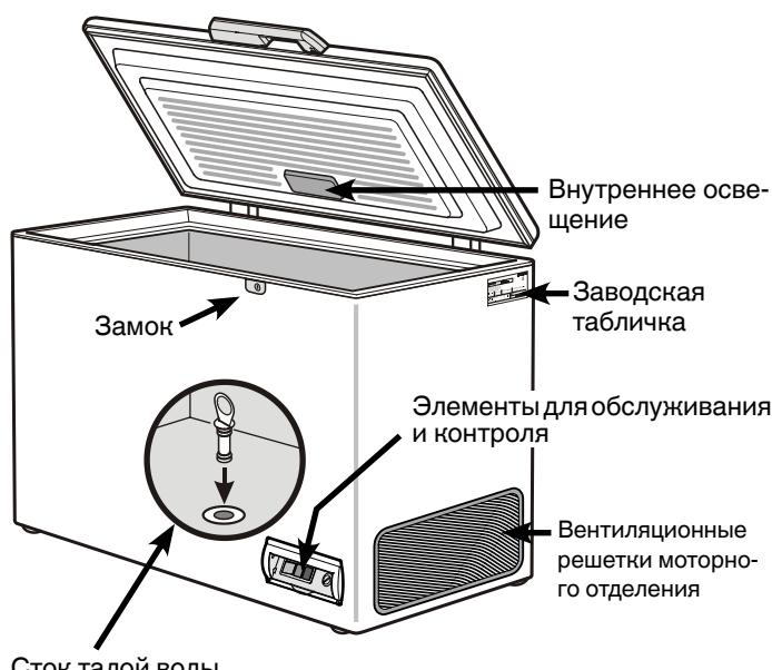
**Перед запуском прибора в эксплуатацию обязательно закройте отверстие стока талой воды в дне прибора прилагающейся пробкой! Это важно для безупречной работы прибора.**
