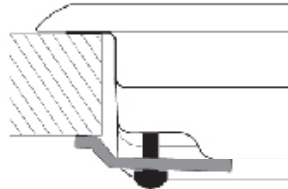
Положение фиксатора при H = 30 \text{ мм}
