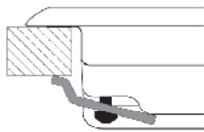
Положение фиксатора при H^* = 20 \text{ мм}
