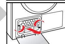
Не допускайте повреждения защитного фильтра и воздушного охладителя!
